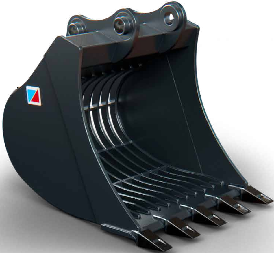
Godet claire-voie SDB : godet de cavage à nervures d'acier laissant passer les matériaux fins au terrassement.
