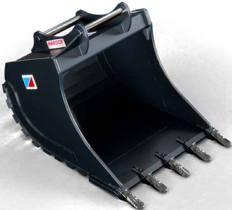
Godet de terrassement renforcé Nordic DSX, fabriqué en Hardox 450.
